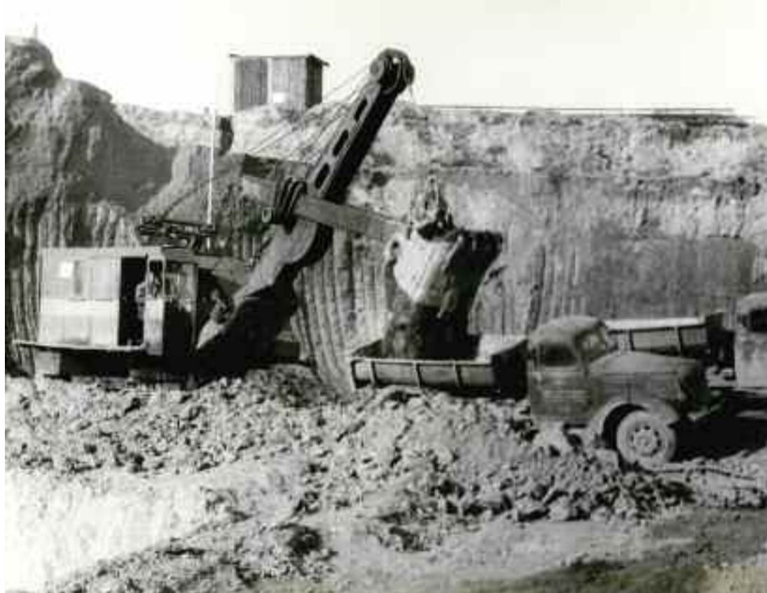
Na takiej koparce Edward Babiński zaczynał pracę. Na zdjęciu: Skoda zdejmująca nadkład na odkrywce Niesłusz.
